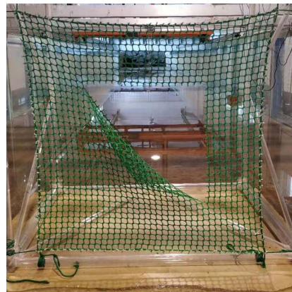
图 3 网衣破损形式
