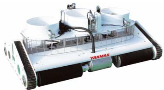
图 6 日本洋马网衣清洗机器人 Fig.6 Aquaculture net cleaning robot in Japan
