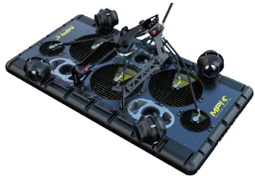
图 5 挪威网衣清洗机器人 Fig.5 Aquaculture net cleaning robot in Norway
