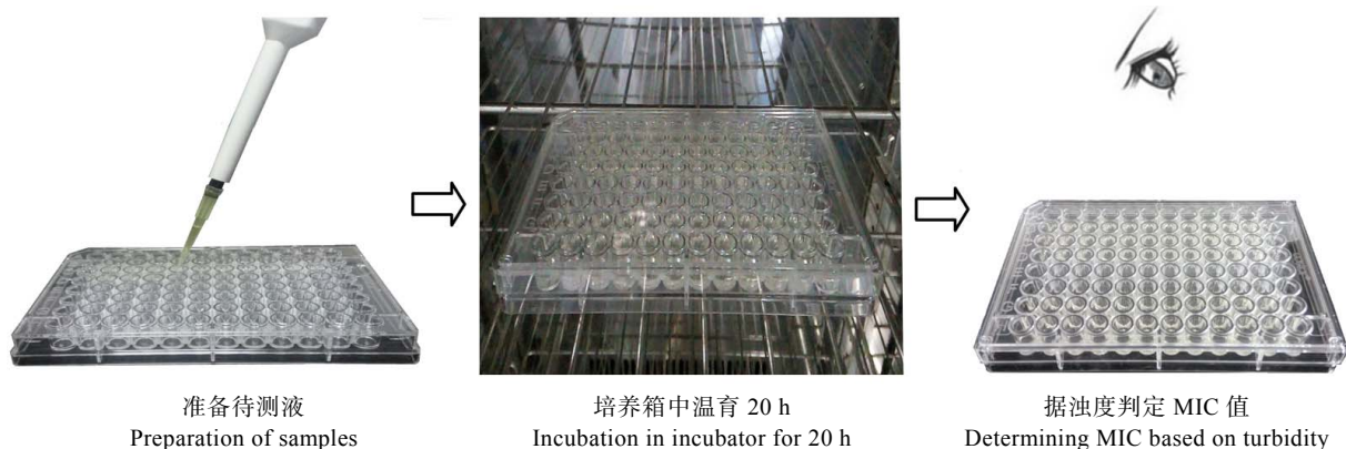
图 2 BMD 法进行 AST 测定的工作示意图
